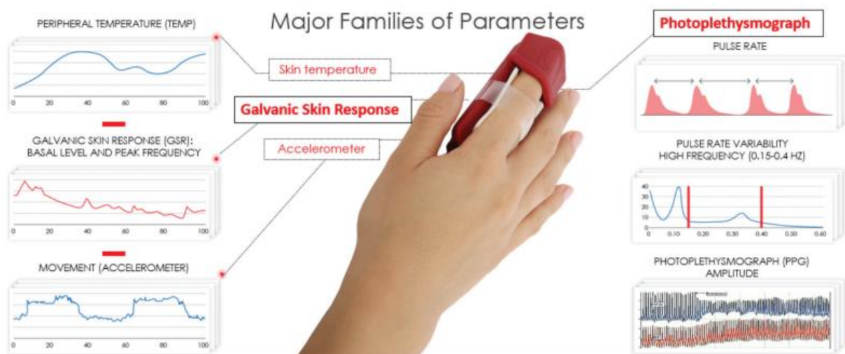
Figura 4 – Segnali e parametri registrati dal NOL
